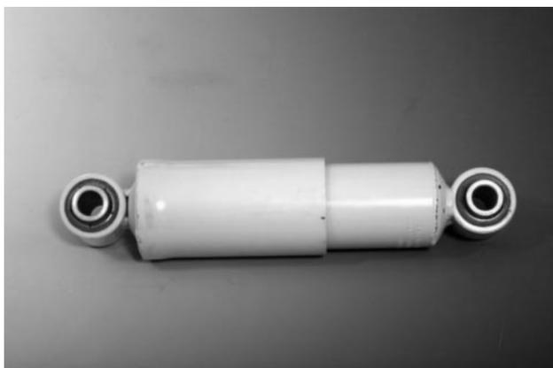
Obr. 6: Tlmič pre návesy kamiónov Renault Brano Ateso Jilemnice
